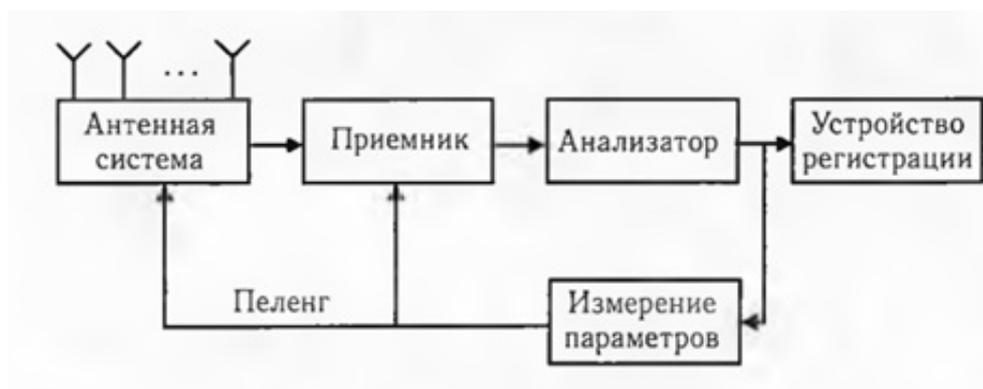
**Рис.** Упрощенная структурная схема станции радиомониторинга
