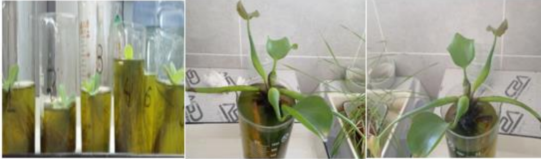
1-rasm. Yuksak suvoʻtlar yordamida oqova suvlarni tozalash jaravoni
