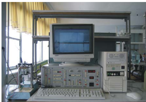
Рис. 1. Внешний вид компьютеризированного комплекса для инверсионной вольтамперометрии.
