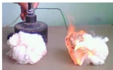
на воздухе огнезащитные текстильные и деревянные материалы обычно получают путем модификации природных материалов общего назначения. Получаемые огнезащитные материалы имеют, как правило, кислородный индекс в пределах 25–27%.
