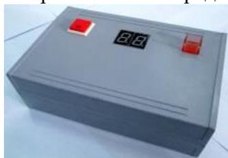
Количественный способ включает подготовку эталонных образцов с различной концентрацией госсипола в них, помещение анализируемого образца в кювету, размещенную между источником излучения и фотоприемником, сравнения их цветов с окрашенным слоем анализируемого образца и определение концентрации госсипола.
