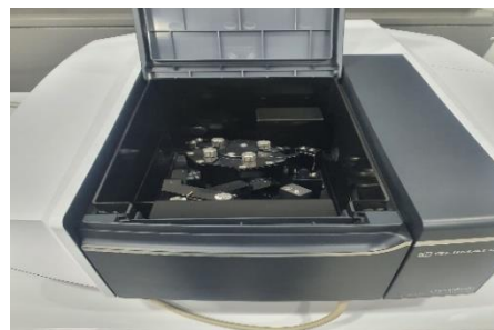
Рисунок 3. Интегрирующая сфера ISR-2600 для получения спектров диффузного отражения
